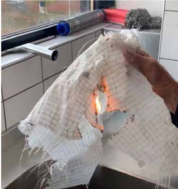
Afbeelding 5.5 Brandproef dampdoorlatende folie
